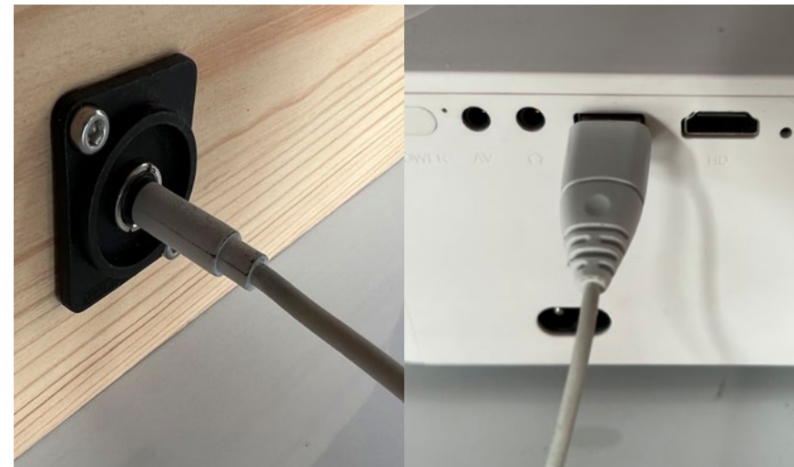
Hem de connectar el cable jack dels altaveus al conector lateral del Sonògraf, i el cable USB dels altaveus al videoprojector
